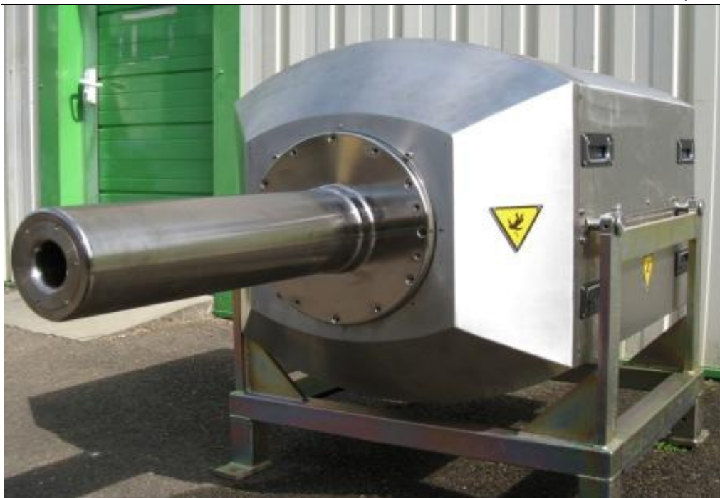
Figura 17: Tocha de plasma de uso industrial (Eurotorch)
